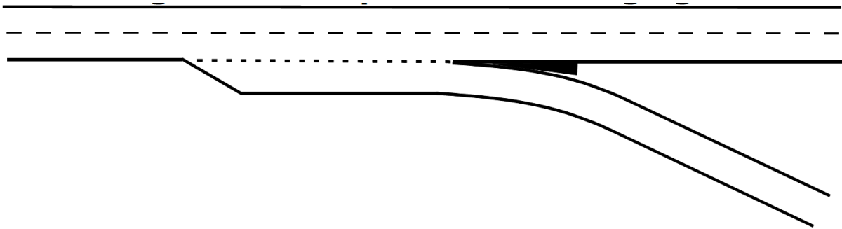
Figuur 8: Principeschets geïsoleerde uitvoegstrook (Bron: Handboek Richtlijnen Ontwerp Autosnelwegen, ROA2017)
