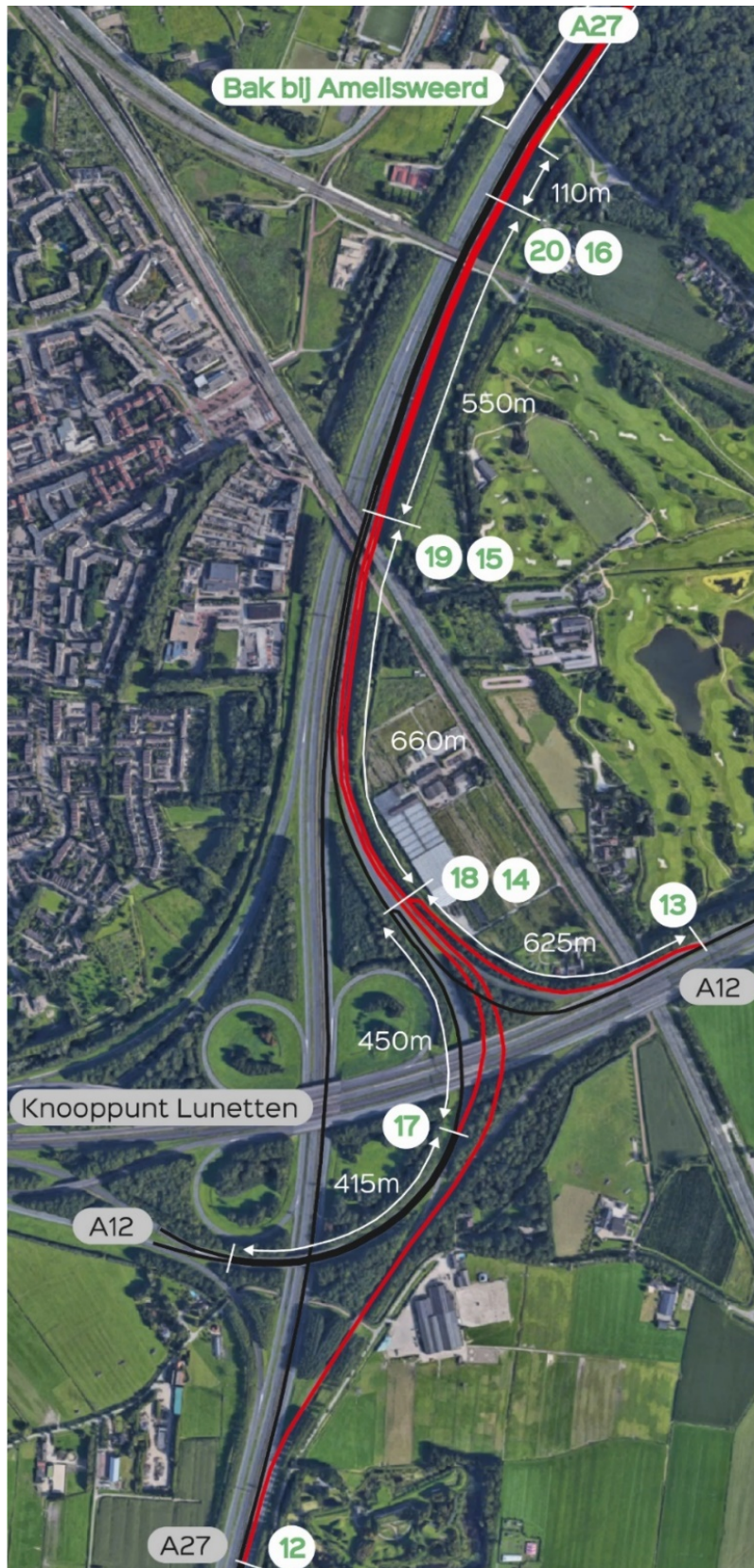
Figuur 12: Toepassing turbulentieafstanden wegvak A27 Knooppunt Lunetten – bak in Amellsweerd
